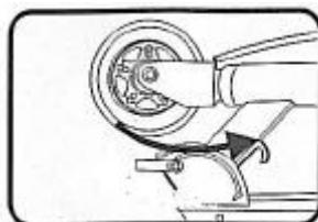
1. Odbezpiecz mechanizm blokujący.
