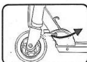
4. Зафиксируйте блокирующий механизм.
