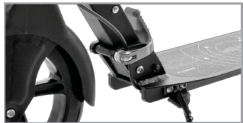
Odomknite páku rýchleho uťahovania
