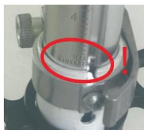
**UWAGA:** Maksymalna wysokość wysunięcia kierownicy jest zaznaczona na pręcie kierownicy. Nie wolno przekraczać zaznaczenia.
