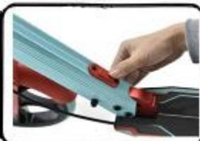
2. Следует нажать блокирующий механизм для разборки самоката.
