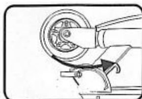
1. Odbezpiecz mechanizm blokujący.
