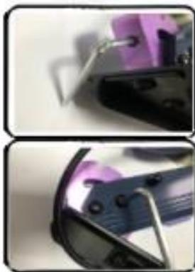
3. Po delším používání se může dostavit vůle v mechanizmu skládání. Dodaným imbusovým klíčem dotáhněte šrouby v mechanizmu.
