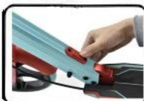
2. Stiskněte páku blokovacího mechanizmu a koloběžku rozložte
