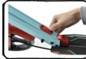
4. Naciśnij mechanizm składania i złóż hulajnogę
