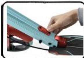
2. Drücken Sie den Hebel des Verriegelungsmechanismus und klappen Sie den Roller auf.
