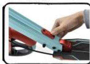
4. Drücken Sie den Hebel des Verriegelungsmechanismus und klappen Sie den Roller zusammen.
