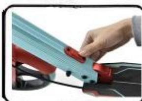
2. Naciśnij przycisk składania i rozłóż hulajnogę.
