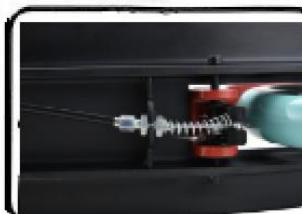
Drehen Sie die Schraube, um die Bremse einzustellen.
