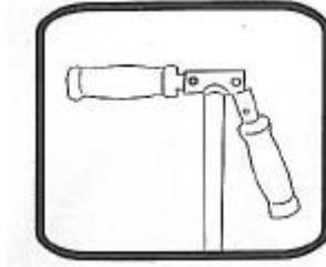
2. Hole die beiden Griffe aus der Lenkradtube raus.
